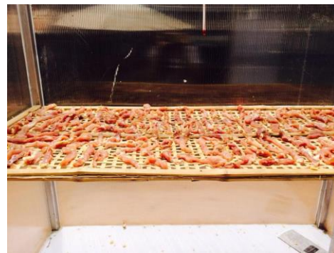
ภาพที่ 1 การจัดเรียงเนื้อหมูภายในตู้อบพลังงานแสงอาทิตย์จากแผ่นโพลีคาร์บอเนต
