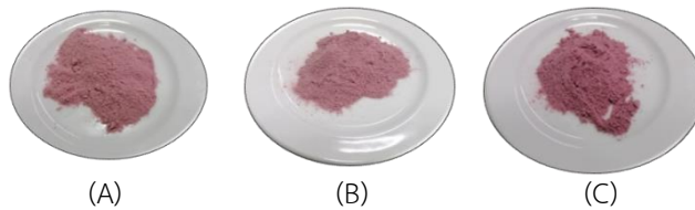
ภาพที่ 1 ลักษณะสีของผงน้ำนมข้าวโพดข้าวเหนียวสีม่วงที่ผ่านการทำแห้งแบบลูกกลิ้งหมุนคู่ โดยใช้อุณหภูมิ 120
