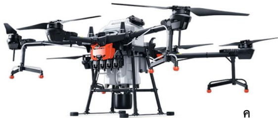
รูปที่ 1 การพ่นสารป้องกันกำจัดโรคเมล็ดต่างด้วยโดรนยี่ห้อ DJI AGRAS รุ่น T20 (ก ข และ ค) และเครื่องพ่นแบบสะพายหลัง (ง)
